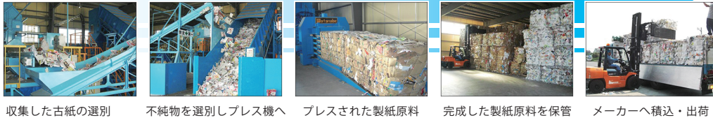
収集した古紙の選別 不純物を選別しプレス機へ プレスされた製紙原料 完成した製紙原料を保管 メーカーへ積込・出荷
